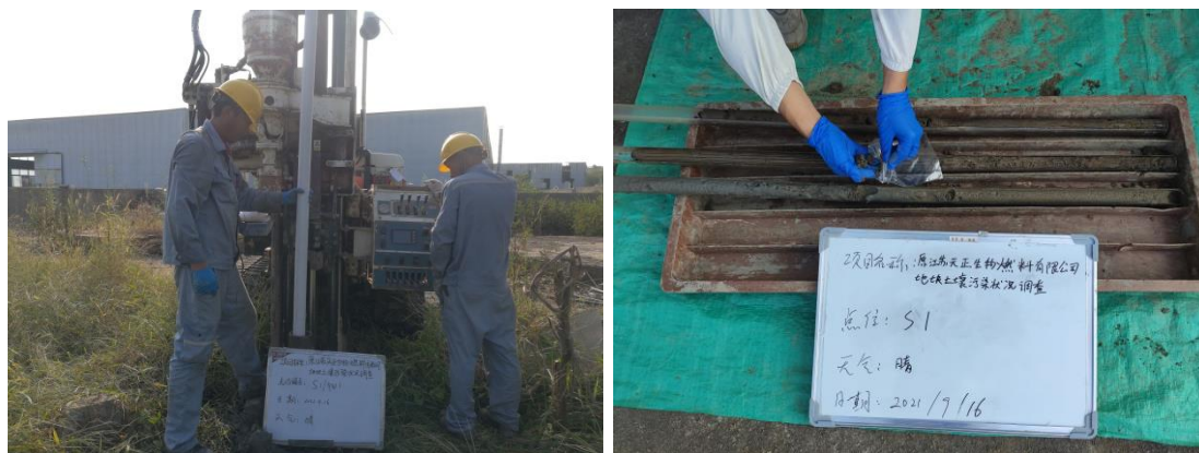
图 3.1-1 现场钻探及采样照片
