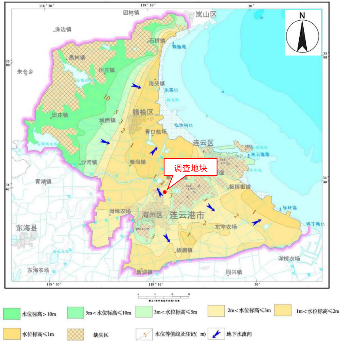
图 3.1-7 连云港市松散层潜水位等值线图 (引自《《连云港城市地质调查报告》(2020 年 12 月)》，p56)
